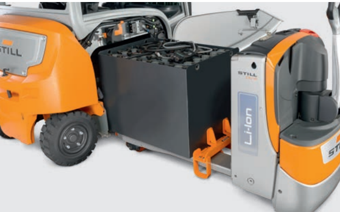
Sostituzione della batteria con transpallet elettrico
