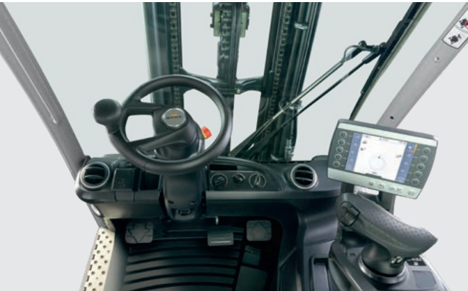
Postazione di lavoro con display e unità di comando, Joystick 4Plus e riscaldamento
